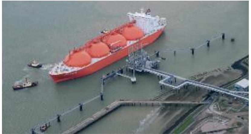
Der Flüssiggas-Transport mit Spezialschiffen ist eine Alternative zu den Erdgas-Pipelines.
