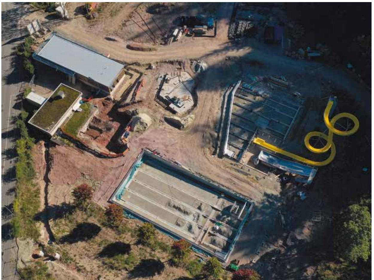
*Das Freibad aus der Vogelperspektive: Links oben das neue sowie das bestehende Technikgebäude, daneben entsteht das Kinderplanschbecken. In der Bildmitte ist das rechteckige Schwimmerbecken zu erkennen, rechts oben das neue Nichtschwimmerbecken mit den beiden Rutschen.*
